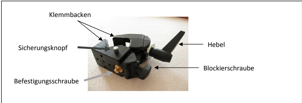
Durch das Drehen des Hebels im Gegenuhrzeigersinn, werden die Klemmbacken soweit geöffnet, dass die Halterung über das Rohr oder die Platte geschoben werden kann.
